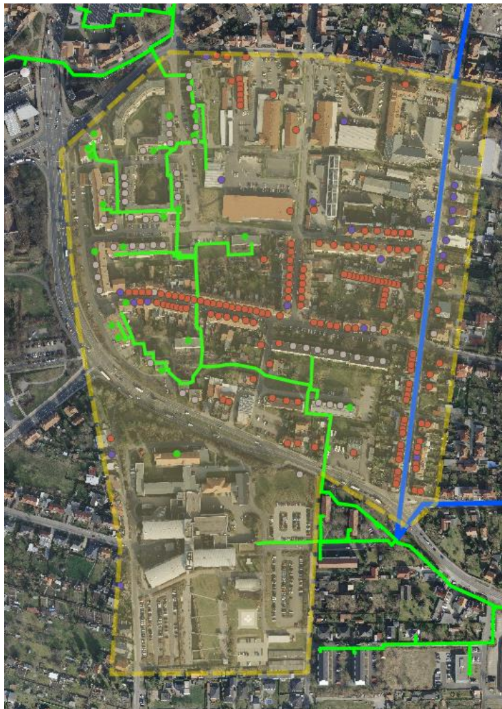
Abbildung 2-9: Wärmeversorgung im Quartier nach Versorgungsarten, rot: Erdgas, grün: Fernwärme, grau: mitversorgt über anderen Hausanschluss, blau: sonstige Wärmeversorgung, grüne Linie: Fernwärmenetz, gelbe Linie: Erdgasnetz Bestand, blaue Linie: Fernwärme geplant (Quelle: eigene Darstellung, Datenbasis Stadtwerke Mühlhausen, OpenStreet-Map)
